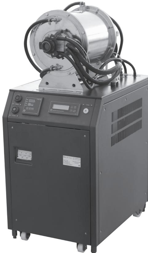
АЧТ может работать в двух режимах - автоматическом и ручном. При выборе автоматического режима работы пользователь задает требуемое значение температуры. При выборе ручного режима работы пользователь сам задает значение подаваемой мощности, влияющее на скорость нагрева и на конечное значение температуры.
