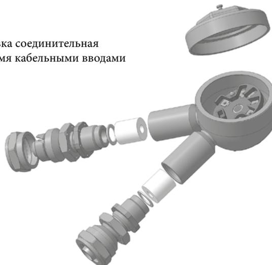
Головка соединительная с двумя кабельными вводами
