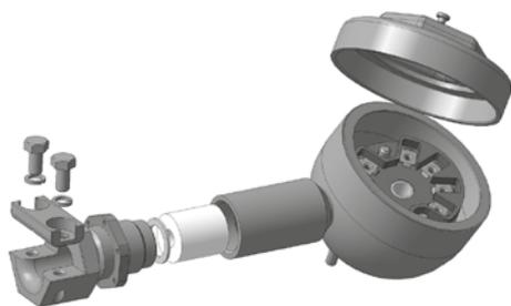
Головка соединительная с одним кабельным вводом
