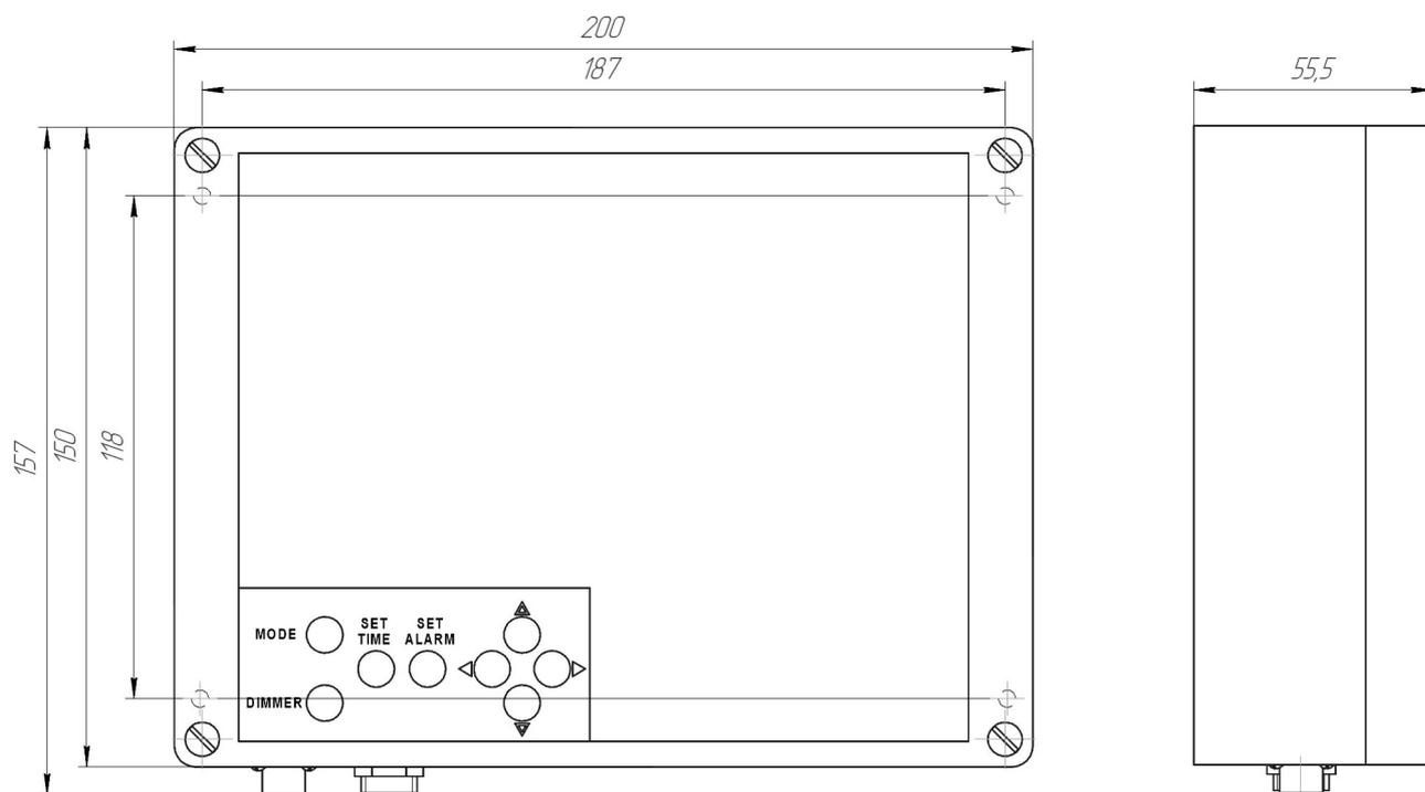
Рисунок А.1 – Габаритный чертеж ИПСС-00, ИПСС-01
