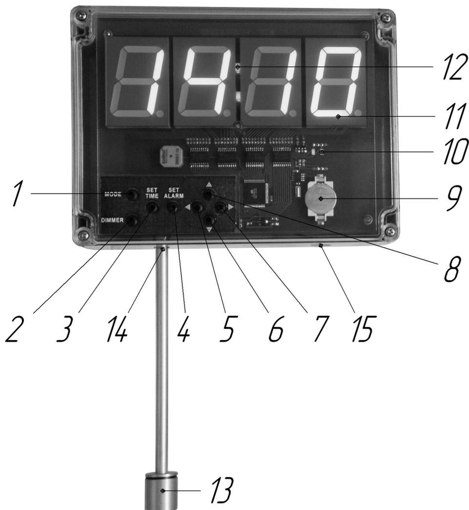
1 – кнопка «MODE»; 2 – кнопка «DIMMER»; 3 – кнопка «SET TIME»; 4 – кнопка «SET ALARM»; 5 – кнопка ◀; 6 – кнопка ▼; 7 – кнопка ▶; 8 – кнопка ▲; 9 – элемент питания для часов; 10 – светодиоды контроля ключей регулирования; 11 – индикатор; 12 – светодиоды разделителя часов и минут; 13 – датчик влажности выносной (из комплекта); 14 – разъем для подключения датчика влажности выносного; 15 – разъем для подключения блока питания (из комплекта).
