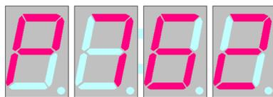
Примечание – Если происходит сбой при измерении какого-либо параметра (вышел из строя или отсутствует датчик и т.п.), то на индикаторе вместо числового значения параметра (например давления) отобразится:
