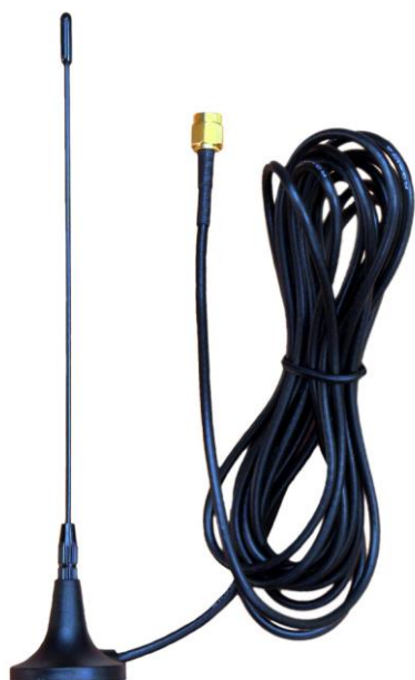
Антенна ВУ-433-06 Габариты: \varnothing 30 \times 170 мм, L_3 = 3,0 м Крепление: магнитное
