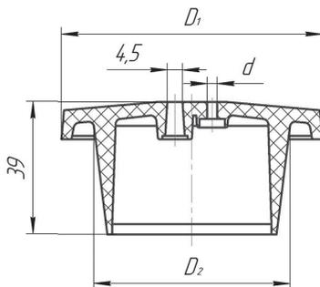
d - диаметр отверстия под крепление тросика
