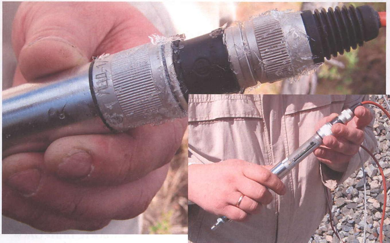
Замеры температуры производились логгером на протяжении всего периода полевых испытаний (7.5 месяцев) четыре раза в сутки. Передача результатов из-
