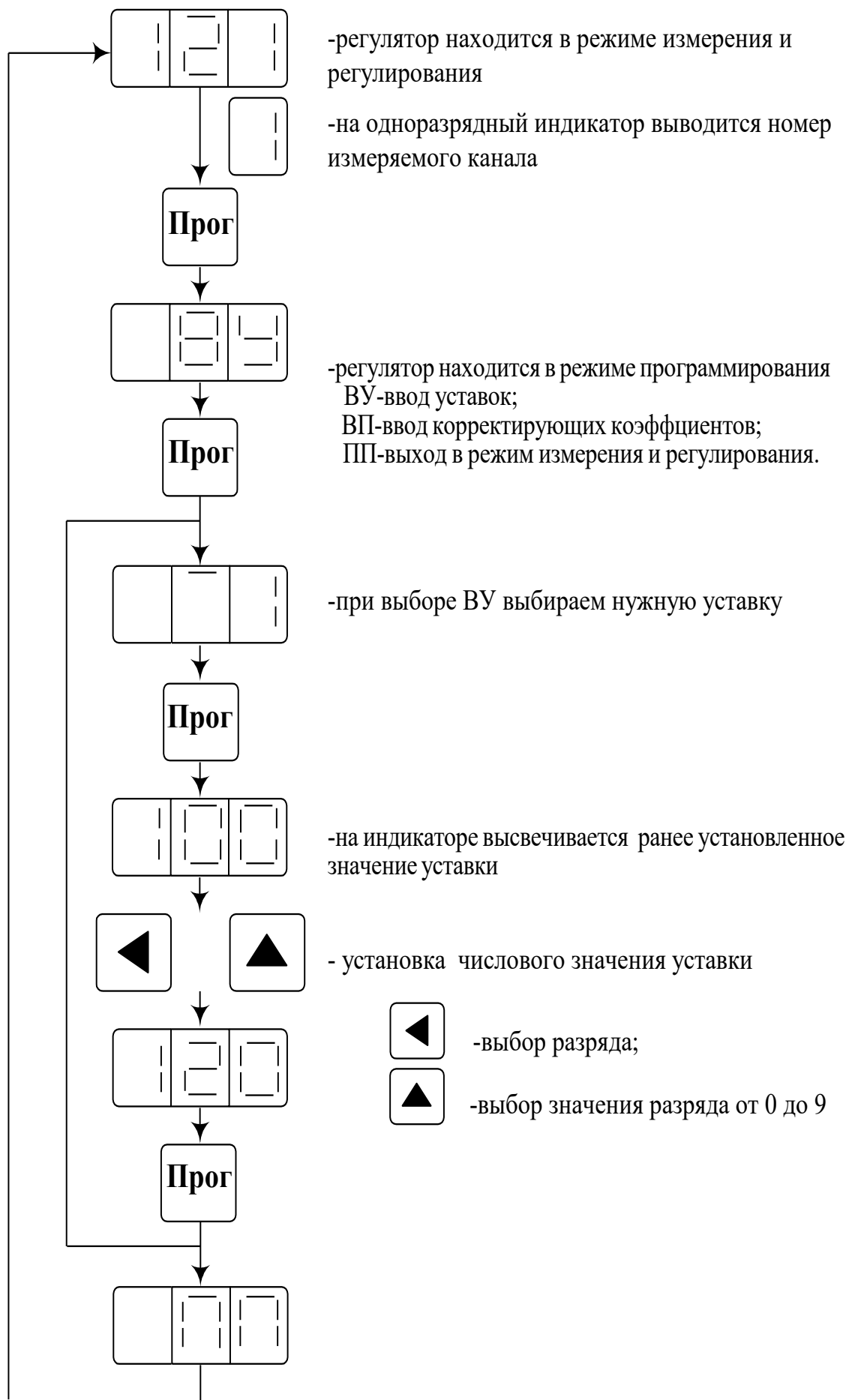
Рисунок 9 – Алгоритм работы регулятора в режиме ввода уставок
